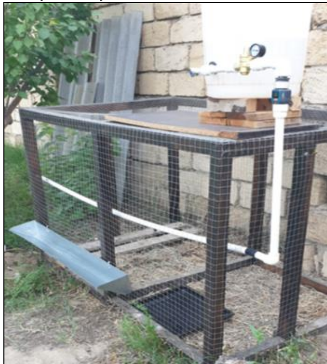
Рис.3 – Общий вид лабораторной установки для проведения экспериментальных исследований процессов капельной подачи воды из поилки с двухклапанной системой шарикового типа для птицы при клеточном их содержании
