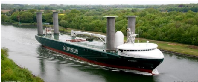
Şəkil 1. 4 ədəd 27 m-lik FLETTNER rotoru ilə təchiz olunmuş Almaniyanın “E-ship 1” adlı gəmisi
