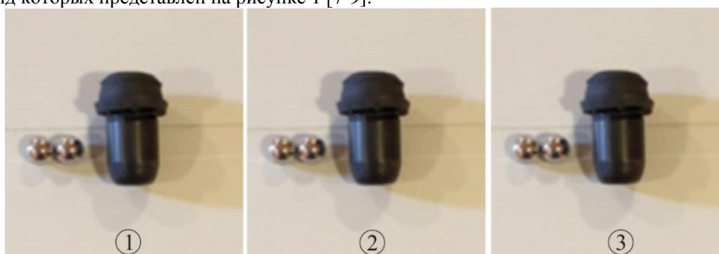
Рис. 1. Общий вид капельных поилок с разными размерами клапанов шарикового типа для птиц при клеточном их содержании: 1 – диаметр выходного отверстия седла клапана d_1 = 5,5 мм; 2 – диаметр выходного отверстия седла клапана d_1 = 6,4 мм; 3 – диаметр выходного отверстия седла клапана d_1 = 7,5 мм
