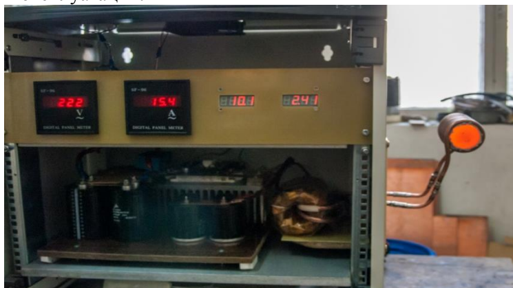
Рис. 2. Индукционный нагреватель в период испытания
