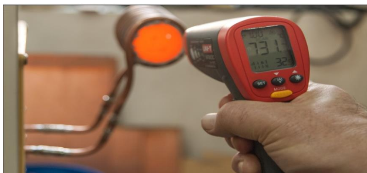
Рис. 3. Процесс индукционного нагрева металла до температуры 731 °C
